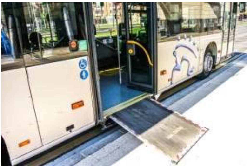
Рисунок 4.19.1 – Автоматический выдвижной пандус для инвалидов
